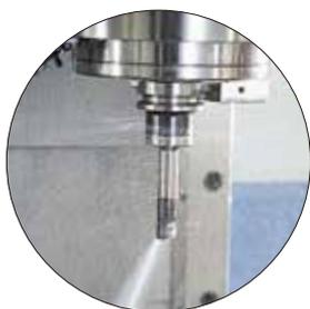
最近のチップ(TiAlNコーティング、CBN)の進歩は目覚ましく、高速切削が実現します。但し、高速用チップは高速切削すること(中低速切削では、加工精度・寿命共に満足出来ない)と、最適なボーリングヘッドを用いることが絶対条件です。ZMACボーリングヘッドをご利用下さい。
