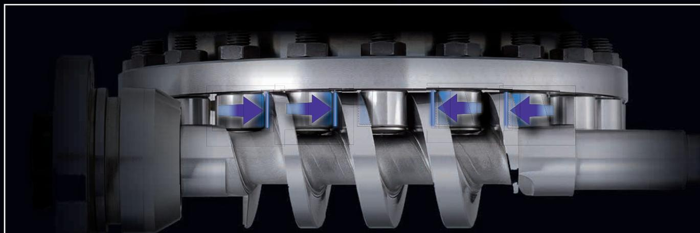
カムシャフト(入力軸)とタレット(出力軸)は、適切な予圧を施したカムフォロアを介して、左右から転がり接触しています。回転しながらトルクを伝達するため、摩擦係数が小さく磨耗し難い構造で定期的なメンテナンスによるバックラッシュ調整が不要です。カムシャフトは、カムフォロアの位置が予圧状態で一致するよう、理論的に計算された形状に高精度加工されており、誤差の無い高い回転精度と割出精度を実現しています。
