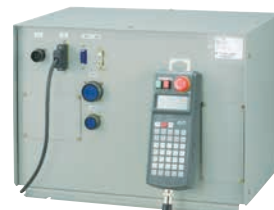
AR21PWコントローラ ・パワーアップ型(1.3kw,1.8kw用) 540×360×400 28kg 入力電源 3相AC200/220V
