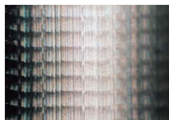
Zero Fit後(刃先の振れ=1μm)
