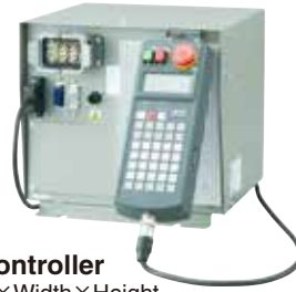
EZ controller Length×Width×Height 260mm×225mm×275mm
