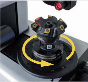
ボタン1つでスピンドルが自動で回転。マルチカッタの刃先を自動認識し、短時間で測定を行うことができます。また測定後、公差から外れた刃先までスピンドルが回転して割出を行うこともでき、大幅な作業時間の短縮が可能です。
