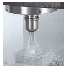
CCKコレット & CKFNネット ジェット噴射で電巻発生
