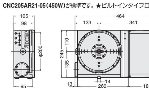
CNC205AR21-05 (450W) が標準です。★ビルトインタイプロータリジョイント6+1ポートの取付が可能です。
