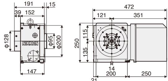
外観寸法は、取付けるサーボモータにより異なります。ここではFANUCモータ付のものを表示しています。各種モータ付のCADデータ 2D(DXF)、3D(PARASOLID)を用意しております。
