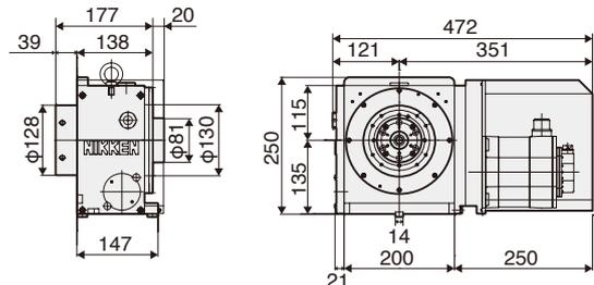
外觀寸法は、取付けるサーボモータにより異なります。ここではFANUCモータ付のものを表示しています。各種モータ付のCADデータ 2D(DXF)、3D(PARASOLID)を用意しております。
